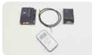
KIT connessione WiFi: centralina, ricevitore LAN, cavo, telecomando.
